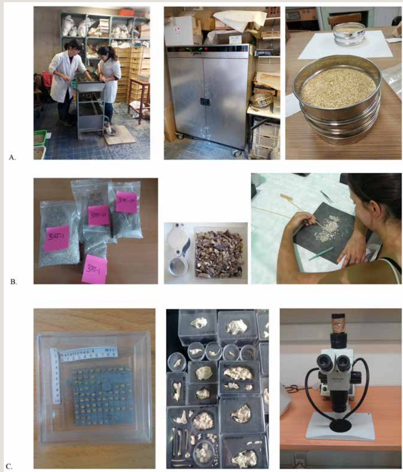
Fig. 1. Procesado del material en el laboratorio y preparación para su estudio. A. Segundo lavado, secado y tamizado de la muestra. B. Triado mediante el uso de lupa de visera o binocular. C. Montaje y siglado usando soportes rígidos y masas plásticas o espuma de polietileno para su estudio con lupa binocular. Fotografías realizadas por Adriana Oliver y Paloma López Guerrero.
